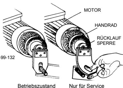
**ACHTUNG:** WENN BEIM DREHEN DES HANDRADES DIE RÜCKLAUFSPERRE AUSGEHÄNGT WURDE (ROTER KUNSTSTOFFLAPPEN), UNBEDINGT VOR INBETRIEBNAHME WIEDER EINHÄNGEN.
