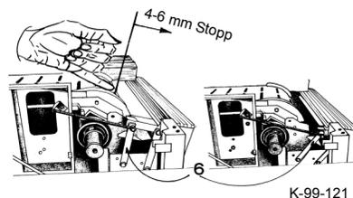
**Test des Sicherheitstores** (bei Option Seitenausstieg) – muss nach max. 15 mm Bewegung abschalten und danach mindestens 300 mm öffnen. Darf nicht vereist sein, Leichtgängig betätigbar mit dem Daumen. Nach Stopp darf der Nachlauf des Fördermittels max. 30 cm betragen. Test aller Haltetaster – noch mal Nachlauf kontrollieren.
